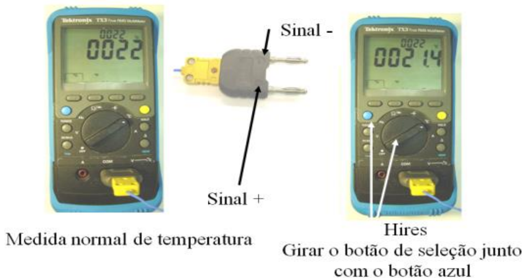
Figura 7: Medida de temperatura do multímetro Tektronix TX3 com o terminal tipo banana (termopar) no modo normal (esquerda) e no modo “alto resolução” (direita).
