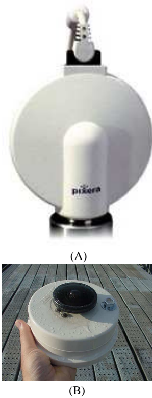
FIG. 4: (A) Câmera Pixera; (B) Câmera e lente unidas dentro do compartimento de PVC.
