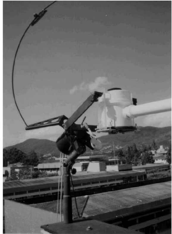
FIG. 1: Protótipo do conjunto composto pela câmera Pixera e lente tipo grande angular montada na UFSC-LABSOLAR. O sistema foi montado com o anel de sombreamento.
