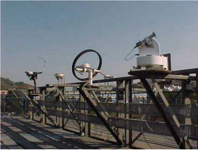
FIG. 5: BSRN Florianópolis – SC Bancada de instrumentos de radiação solar visto na da foto: (A) Pirheliômetro de cavidade absoluta, visto a direita da foto; (B) Piranômetro com anel de sombreamento logo após o Pirheliômetro. Fonte: Sylvio Mantelli
