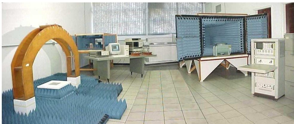
Figura 2. Vista geral do Laboratório de Caracterização Eletromagnética da Divisão de Materiais/IAE/CTA com duas câmaras anecóicas ao fundo e o arco NRL à esquerda.
