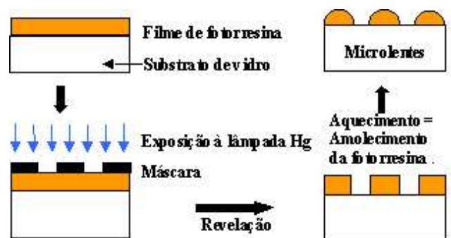
Figura 1. Esquema da confecção de microlentes pelo processo de amolecimento da fotorresina. O aquecimento da fotorresina deforma os cilindros anteriormente gravados resultando em calotas esféricas.
