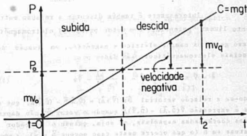
Fig. 3 - Gráfico  $P \times t$ . Objeto Lançado Verticalmente com  $v_0$ .
