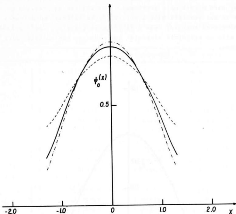
Figura 3 - Função de onda do estado fundamental ( $\psi_0$ ) para  $\nu=8$  usando os valores exato (-.-.-), de Turschner (—) e W.K.B. (----) para a energia. [Fazemos a unidade de comprimento no eixo  $x$ ,  $\underline{a}=1$  e o valor do passo,  $H=0.05$ ].
