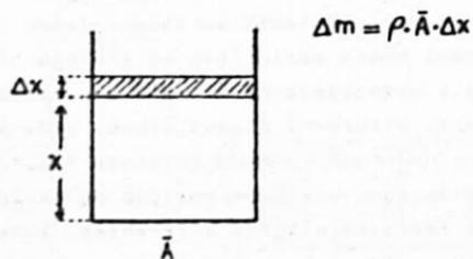
Fig. 5b- Carregar um copo com líquido significa acrescentar camadas  $\Delta x$  de líquido, e para isto gastamos uma energia ( $\Delta U_h$ ) para elevar uma massa de líquido  $\Delta m$  na altura  $x$ .
