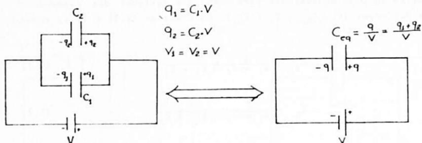
Fig. 4a- Dois capacitores associados em paralelo são equivalentes a um capacitor que armazena uma quantidade de carga igual à soma das cargas ( $q = q_1 + q_2$ ) armazenadas em cada um dos capacitores, quando submetidos à mesma d.d.p. ( $V = V_1 = V_2$ ).
