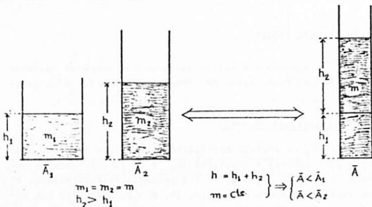
Fig. 3b- O an\u00e1logo hidr\u00e1ulico do capacitor equivalente a 2 capacitores el\u00e9tricos em s\u00e9rie \u00e9 a substitui\u00e7\u00e3o de 2 copos por um outro que armazena a mesma quantidade de l\u00edquido, com uma altura igual \u00e0 soma das outras duas ( $h = h_1 + h_2$ ).
