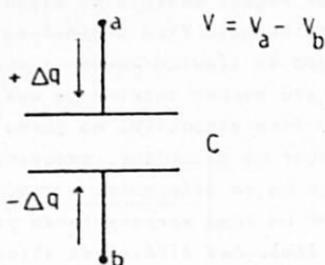
Fig. 5a- Carregando um capacitor temos que separar, a cada momento, uma quantidade de carga  $\Delta q$ , contra uma certa d.d.p. ( $V$  é variável), e para isto gastamos uma certa quantidade de energia  $\Delta U$ .
