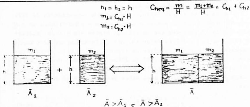
Fig. 4b- O análogo hidráulico do capacitor elétrico equivalente é a substituição de 2 copos com a mesma altura de superfície livre do líquido ( $h = h_1 = h_2$ ), por outro copo equivalente que armazena uma quantidade de líquido igual à soma das quantidades armazenadas nos outros dois ( $m = m_1 + m_2$ ) com a mesma altura ( $h$ ) da superfície livre do líquido.
