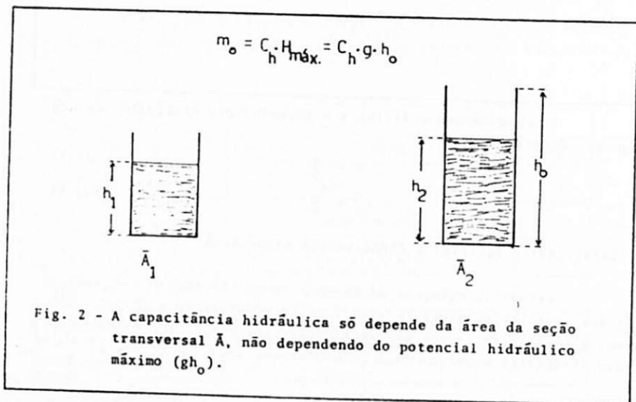
Fig. 2 - A capacitância hidráulica só depende da área da seção transversal  $\bar{A}$ , não dependendo do potencial hidráulico máximo ( $gh_o$ ).
