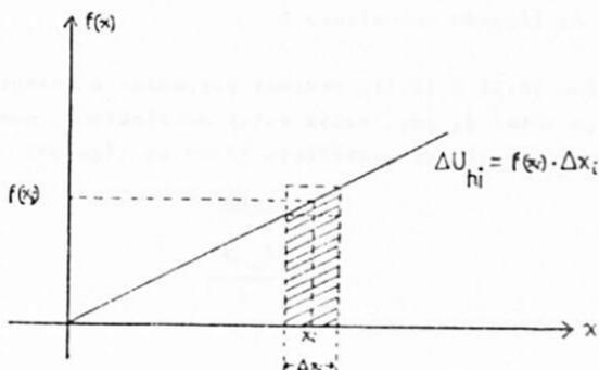
Fig. 6- A variação da energia potencial ( $\Delta U_{hi}$ ) será a área do trapézio ( $\Delta U_{hi} = f(x_i) \cdot \Delta x_i$ ) hachurado.
