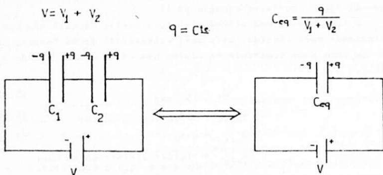
Fig. 3a- Dois capacitores associados em s\u00e9rie (portanto armazenam a mesma quantidade de carga) s\u00e3o equivalentes a um capacitor ( $C_{eq}$ ) que armazena a mesma quantidade de carga ( $q$ ), quando submetido \u00e0 mesma d.d.p. ( $V$ ), igual \u00e0 soma da d.d.p. de cada um dos capacitores ( $V = V_1 + V_2$ ).
