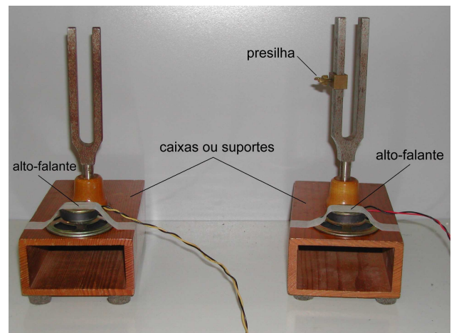
Figura 2 - Aspecto da montagem experimental com os dois diapasões. Note que um deles há uma presilha presa em um dos lados da forquilha. Esta presilha tem a função de alterar (abaixar) a frequência característica do diapásão.
