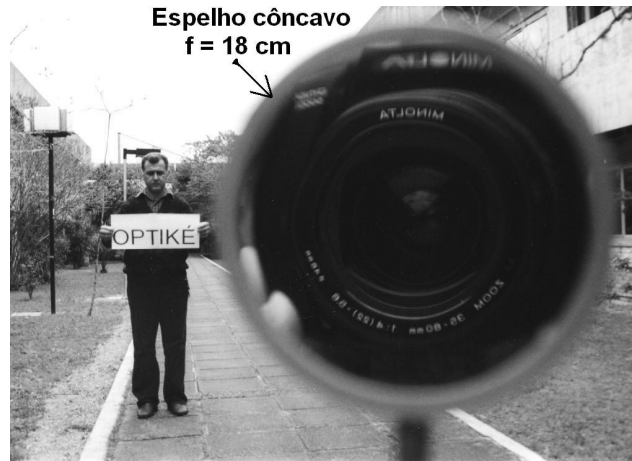
Figura 13 - Fotografia mostrando a objetiva da máquina fotográfica localizada no plano focal do espelho côncavo. O espelho está contido na moldura que na foto aparece pouco nítida.
