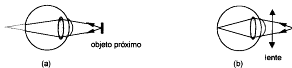
Figura 2. (a) Olho hipermetrope e (b) sua correção através de uma lente convergente.
