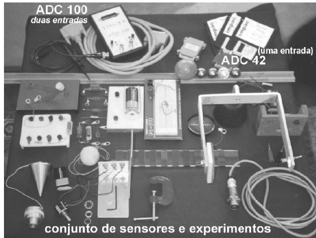
Figura 1. Distribuição do conjunto de sensores e conversores ADC 42 e 100.
