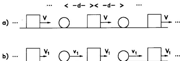
Figura 3. O sistema infinito de massas  $M$  e  $m$  equidistantes de  $d$ , inicialmente na configuração a). Depois do tempo  $d/V$  a configuração seria a b), o sistema oscilando entre ambas com período  $t$ .
