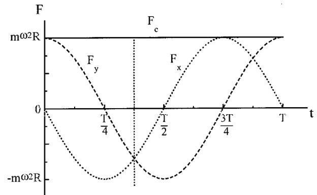
Figura 3. Representação gráfica de  $F_c$  (linha contínua) e de suas componentes  $F_x$  (linha pontilhada) e  $F_y$  (linha tracejada). A linha vertical identifica o ponto P da figura 2:  $F_c = (F_x^2 + F_y^2)^{1/2}$ .
