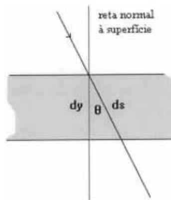
Figura 1: A radiação atravessa um comprimento  $ds$ , de uma camada de espessura  $dy$ , formando com a reta normal à superfície um ângulo  $\theta$ .
