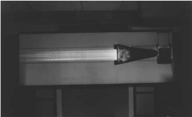
Figura 1. Foto do painel mostrando o projetor de slides, a lente colimadora, o obstáculo com fendas horizontais e os feixes que são traçados no painel.
