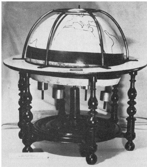
Figura 3 - Modelo de Kelvin da Terra com precessão. O globo, apoiado no centro de gravidade, mostra a precessão dos equinócios pela haste rolando e pressionando contra o anel limitador.
