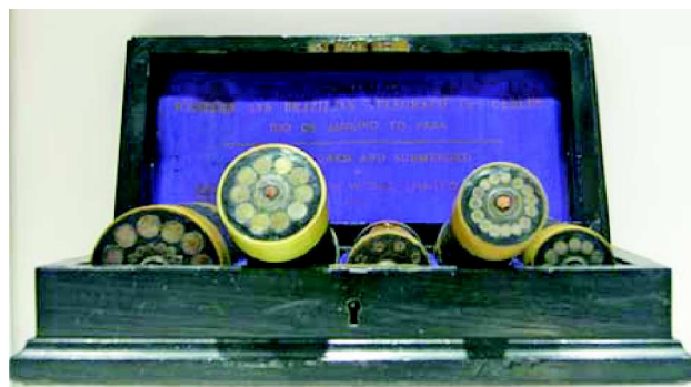
Figura 3 - Estojo contendo amostras de cabos submarinos utilizados pela Western and Brazilian Telegraph Company na linha Pernambuco-Pará. Cortesia do Hunterian Museum , Glasgow, Escócia.
