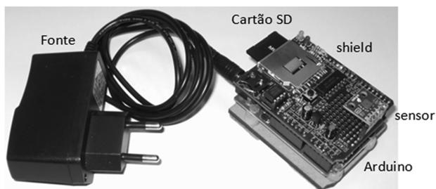
Figura 3 - Montagem experimental completa. Para maior portabilidade, esse equipamento também pode ser alimentado por bateria.
