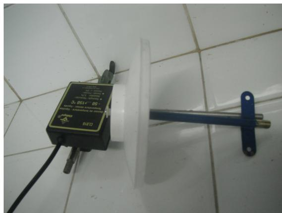
Figura 5 - Eixo de atrito final, com duas pás.
