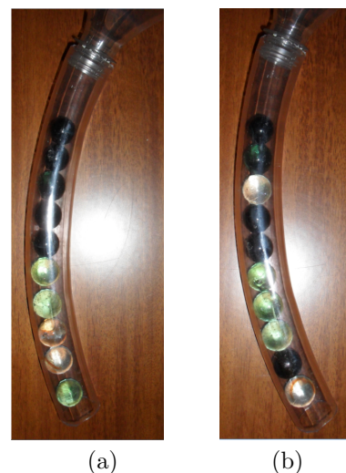
Figura 3 - (A) Disposição padrão. O gás ocupa um volume de 5 bolas, na parte superior da mangueira e (B) uma possível disposição.
