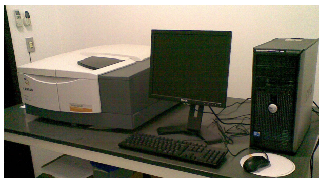
Figura 13 - Espectrômetro para obtenção de espectros no infravermelho instalado no Instituto de Física/UFMT.
