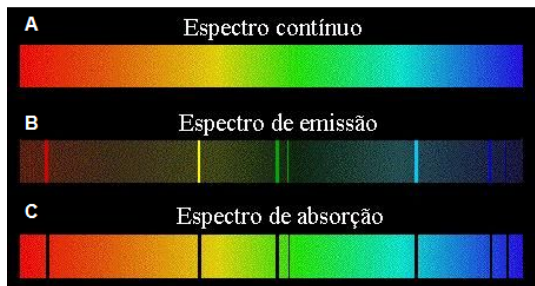
Figura 7 - A) Espectro contínuo, produzido por uma fonte que emite luz em todos os comprimentos de onda da faixa a ser analisada, no caso o visível; B) Espectro de emissão do elemento; C) Espectro de absorção do elemento. Figura adaptada. Fonte: Ref. [13].
