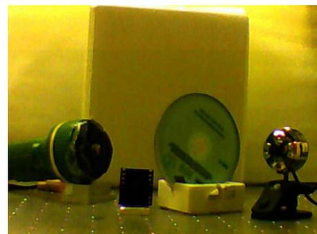
Figura 7 - Equipamentos utilizados na montagem do experimento 2: lanterna com lâmpada de filamento, DVD, *webcam* modificada, computador, anteparo e filme fotográfico revelado.
