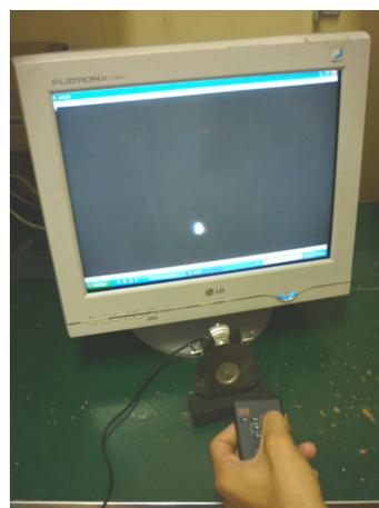
Figura 6 - Experimento mostrando a existência de luz invisível (radiação infravermelha). O *LED* de um controle remoto, cuja radiação não pode ser enxergada pelos olhos humanos, é identificado por uma *webcam*.
