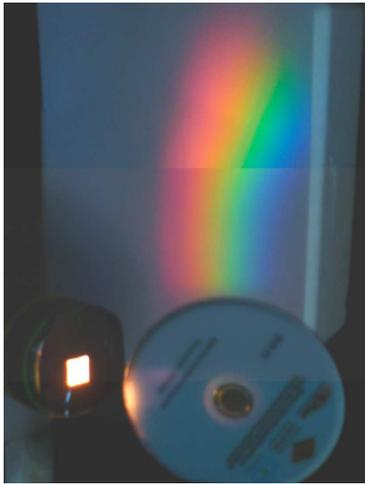
Figura 8 - Decomposição da luz branca de uma lanterna por um DVD através do fenômeno da difração. Fotografia obtida com uma câmera convencional cujo filtro de infravermelho não foi removido.
