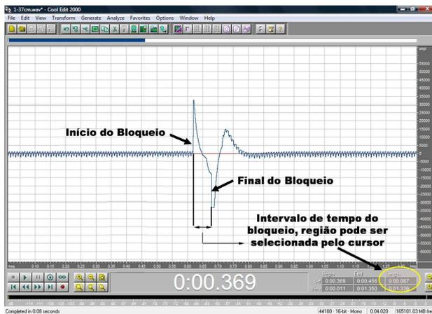
Figura 3 - O sinal mostra o tempo de bloqueio de incidência de luz no sensor acoplado na entrada de microfone da placa de som, bloqueio esse ocasionado pela passagem da bola de bilhar de diâmetro  $(5,647 \pm 0,002)$  cm na saída do trilho.
