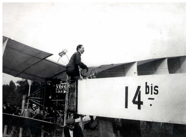
Figura 5 - O “Oiseau de Proie I” em 13 de setembro de 1906 no campo de Bagatelle (Paris, França), já com o motor de 50 cavalos instalado (Fonte: Arquivo Nacional).
