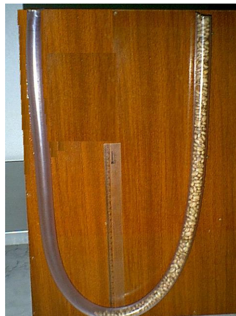
Figura 6 - Tubo em U feito de borracha transparente com um metro de comprimento total e 20 cm de diâmetro. Grãos de feijão foram adicionados lentamente por uma das extremidades. Os grãos não ocupam as duas metades do tubo.
