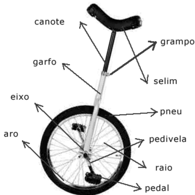
Figura 1 - Componentes de um monociclo.
