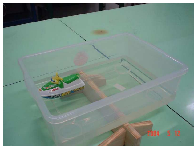
Figura 2 - A cuba está em equilíbrio com a lancha afastada do eixo de apoio.
