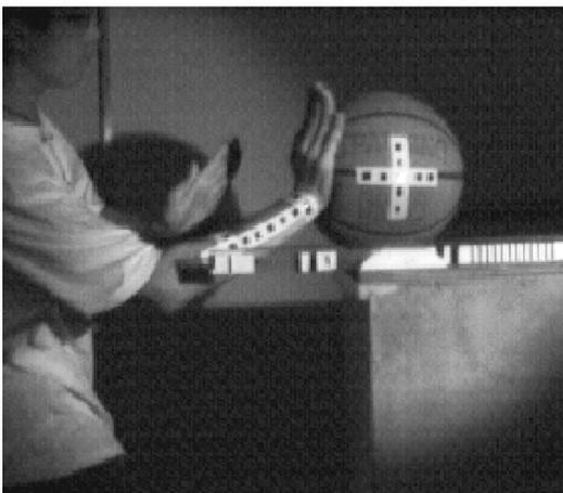
Figura 3 - Imagem do impacto registrada pela câmera rápida. Os contrastes de cores no braço e na bola indicam os pontos usados como marcas para obtenção de posições na análise. Os contrastes de cores na régua foram usados para determinar a escala de conversão de pixels em cm da imagem.
