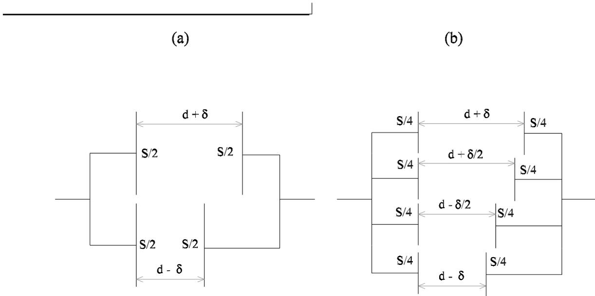
Figura 3 - Sucessivas associações de capacitores em paralelo. Em (a),  $n = 2$ ; em (b),  $n = 4$ .
