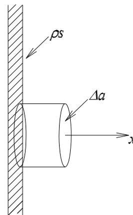
Figura 1 - Superfície cilíndrica de Gauss numa placa do capacitor. A Placa possui a densidade superficial de cargas  $\rho_s$ .
