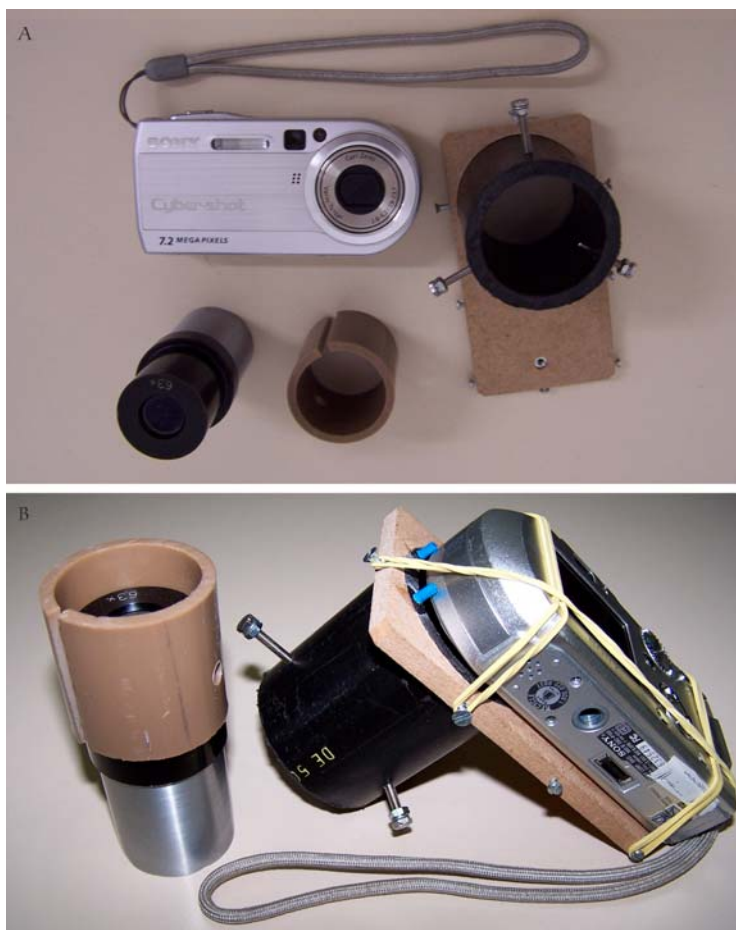
Figura 5 - A - Foto do dispositivo. Os três parafusos de fixação da ocular foram dotados de uma porca extra, de modo a facilitar o manuseio. Os parafusos laterais, fixos no suporte de madeira, servem para prender a câmera. O anel de PVC, acima da câmera, permite a adaptação da ocular ao dispositivo, praticamente sem folgas. B. Atilhos de borracha fixam a câmera ao dispositivo, de maneira segura e sem danos a ela. Os dois pinos, próximos à câmera, evitam que ela se mova em relação ao tubo adaptador. O tubo de PVC, sobre a ocular, ajusta-se ao tubo do dispositivo. As fotos das Figs. 6 e 7 foram obtidas com o equipamento aqui mostrado, acoplado a um dos lados de uma lupa binocular.
