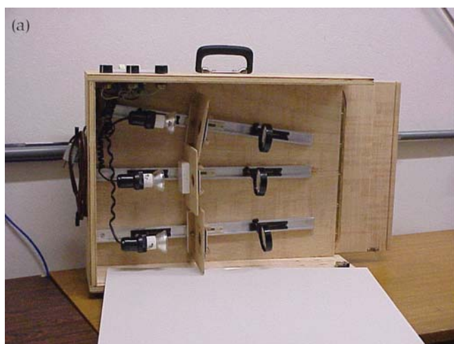
Figura 2 - (a) Vista superior da “caixa de cores” com três projetores de slides, caseiros, contendo trilhos ópticos de alumínio, lâmpadas dicrômicas, porta-slides com filtros coloridos e lentes. O tampo branco da caixa é removível (na parte inferior da foto) e pode ser utilizado como anteparo. (b) Vista frontal mostrando os filtros coloridos e as lentes.
