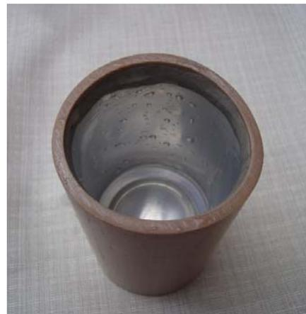
Figura 4. Recipiente coletor visto de cima. É composto por um cano de PVC, que é isolante elétrico, com uma lata de alumínio em seu interior.
