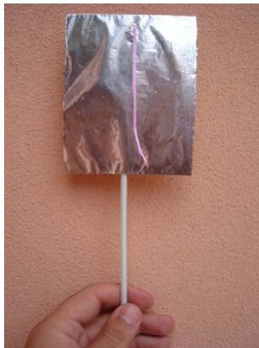
Figura 2. Foto do eletroscópio construído.
