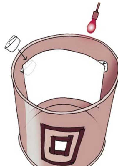
Figura 6. Papel fotográfico colado na parte interna da lata, oposto ao pequeno orifício. Deve ser colocado na escuridão ou com luz ambiente vermelha, pois o papel só pode ser manipulado sob essa iluminação.
