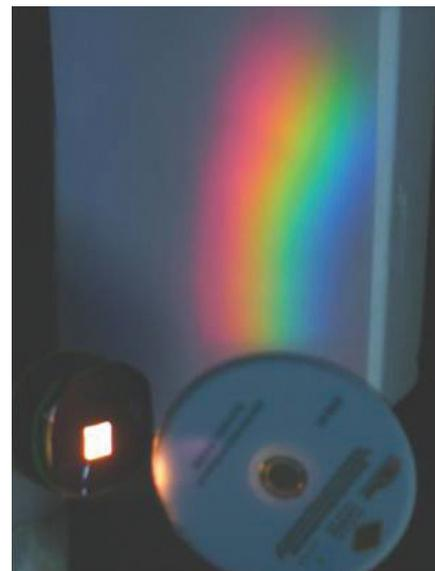
Figura 8 - Decomposição da luz branca de uma lanterna por um DVD através do fenômeno da difração. Fotografia obtida com uma câmera convencional cujo filtro de infravermelho não foi removido.
